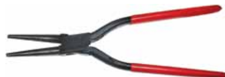
In acciaio forgiato, per pieghe arrotondate, braccio di leva studiato per minimizzare lo sforzo sui becchi da 45 mm, becchi temperati e leggermente arrotondati. Punta dei becchi dentata. Manici plastificati in rosso. Forged steel, for rounded folds, lever arm designed to minimize stress on the jaws of 45 mm, hardened jaws slightly rounded. Tip of the jaws toothed. Handles plastic coated in red.
