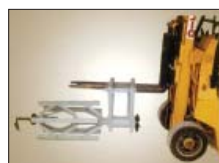
Inserimento delle forche. Insertion of the forks.
