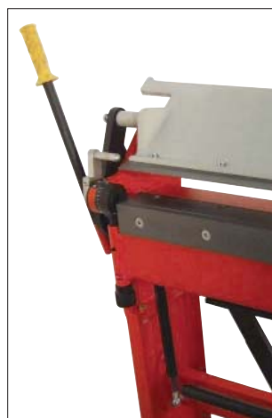
Apertura ganasce di 100 mm. 100 mm mouth opening.
