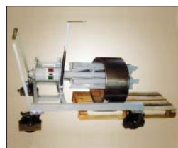
Inserimento nel coils. Coil insertion.
