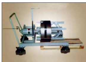
Espansione del nocciolo per mezzo della maniglia posteriore. Expansion of the Kernel using the back handle.
