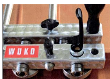
Sistema di leve eccentriche specifico. System of eccentric lever with disc springs.
